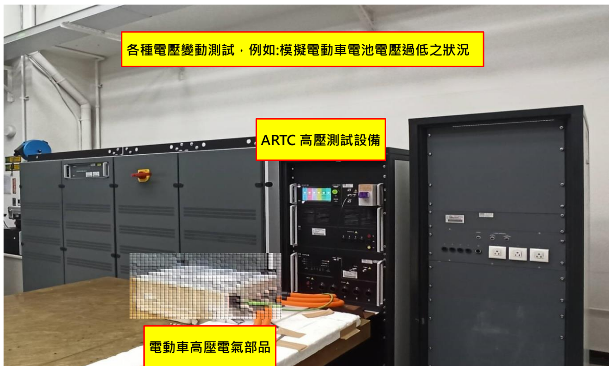
圖 2、國際標準 ISO 21498 測試驗證架構
